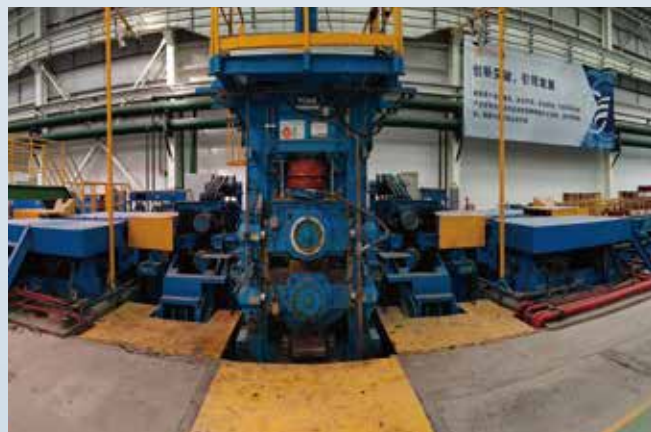
棒材 咸阳钛业钛合金大棒轧制项目 国内首创超大断面钛合金“以轧代锻”新工艺 开创航空级钛合金“一火成材”高效轧制新模式 开发世界最大的BDM850成套轧制装备及控制系统
