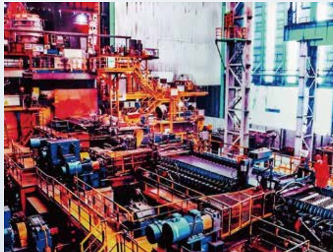
热轧带钢 沙钢CASTRIP®超薄带生产线 亚洲首例工业化CASTRIP®超薄带产线 国内独家技术和装备成套负责 产线仅长约50m, 低碳环保, 产品为低碳钢、高强度 荣获冶金行业勘察设计一等奖、工程设计优秀成果一等奖
