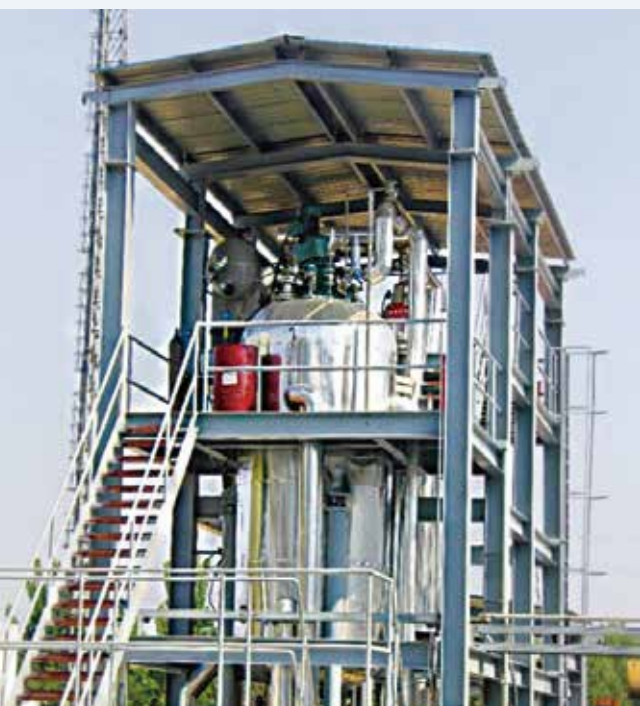
■ 污水处理及污泥处理处置 济宁中山水务有限公司污泥水热碳化 (HTC) 示范工程 污泥处理量45t/d
