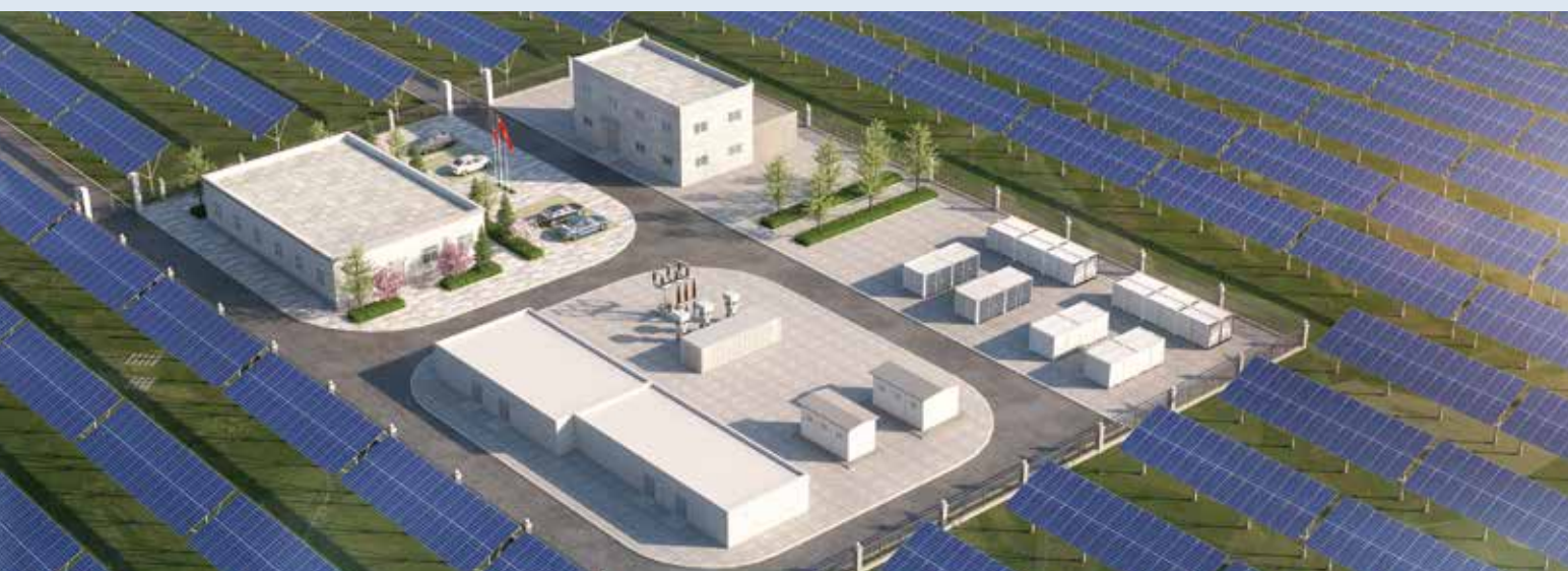
■ 新能源光伏发电 临沂沂堂35MW光伏发电项目 建设1座35kV开关站、35MW光伏发电装置、储能系统、接入系统及配套设施
