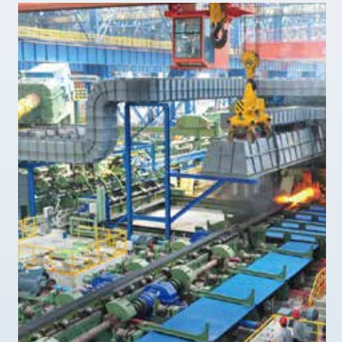
钢管 江苏天淮508机组项目 世界最大规格的三辊连轧管机组
